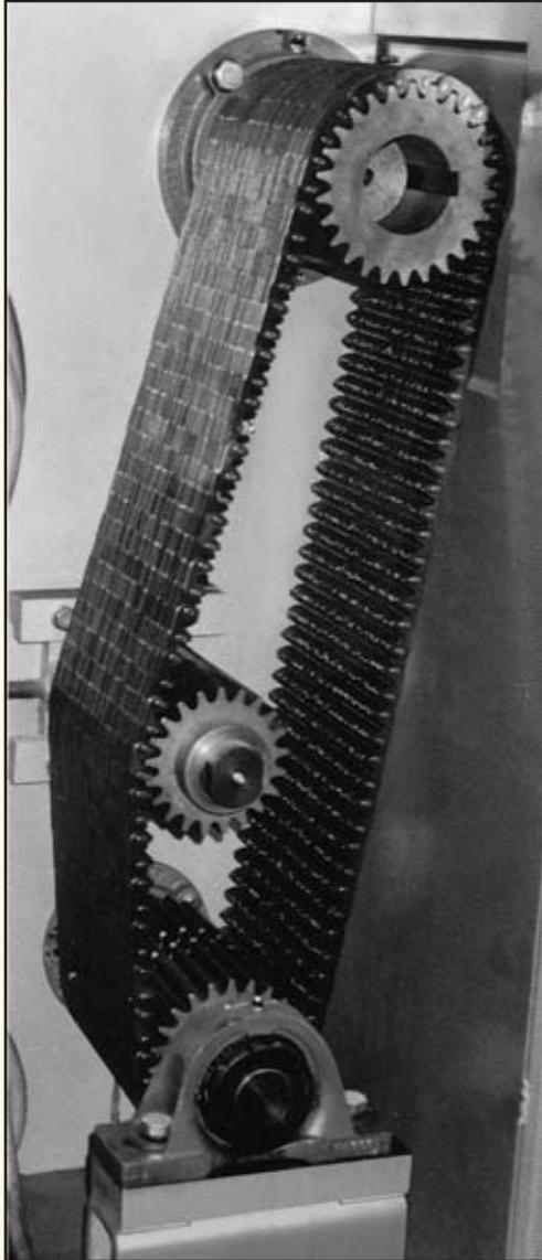
*Accionamiento principal en máquina de inyección de film plástico*
