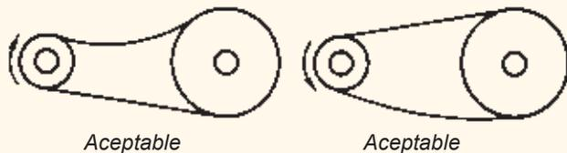
Las transmisiones verticales deben evitarse siempre que sea posible. En este tipo de sistema las cadenas deben estar siempre tensas, lo que significa que se debe ajustar con frecuencia la distancia entre centros a medida que la cadena sufre el estiramiento debido a su uso normal. Se requerirá menos cuidados y ajustes si la transmisión puede situarse ligeramente inclinada.
